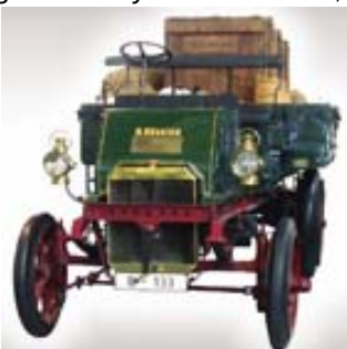
Büssing ZU 550 van 1903 2 cilinder van 2250cc, 9 pk, 15 km/u, 3450 kg + 2 t vracht.
